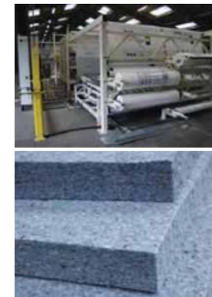
Ouvert depuis 2012 au cœur du Parc industriel Artois-Flandres (62), l'usine de production de Métisse, isolant thermique et acoustique bio sourcé conçu à partir de coton recyclé, a consolidé en 2013 son process de fabrication, notamment par l'installation d'une ligne de conditionnement des produits. En parallèle, le Relais s'est associé début 2013 à une entreprise industrielle
