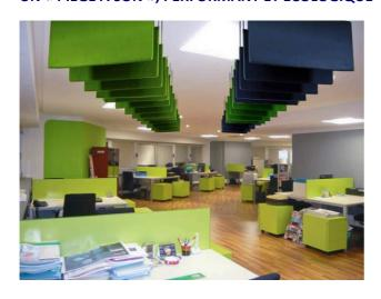
Conçus à base de l'isolant bio-sourcé Métisse®, les panneaux [eko] baffles exploitent les exceptionnelles performances acoustiques du coton recyclé dont il sont composés. En effet, le coton se comporte comme un véritable piège à sons, qui permet d'absorber jusqu'à 95% des ondes sonores, selon les tests réalisés en laboratoire.
